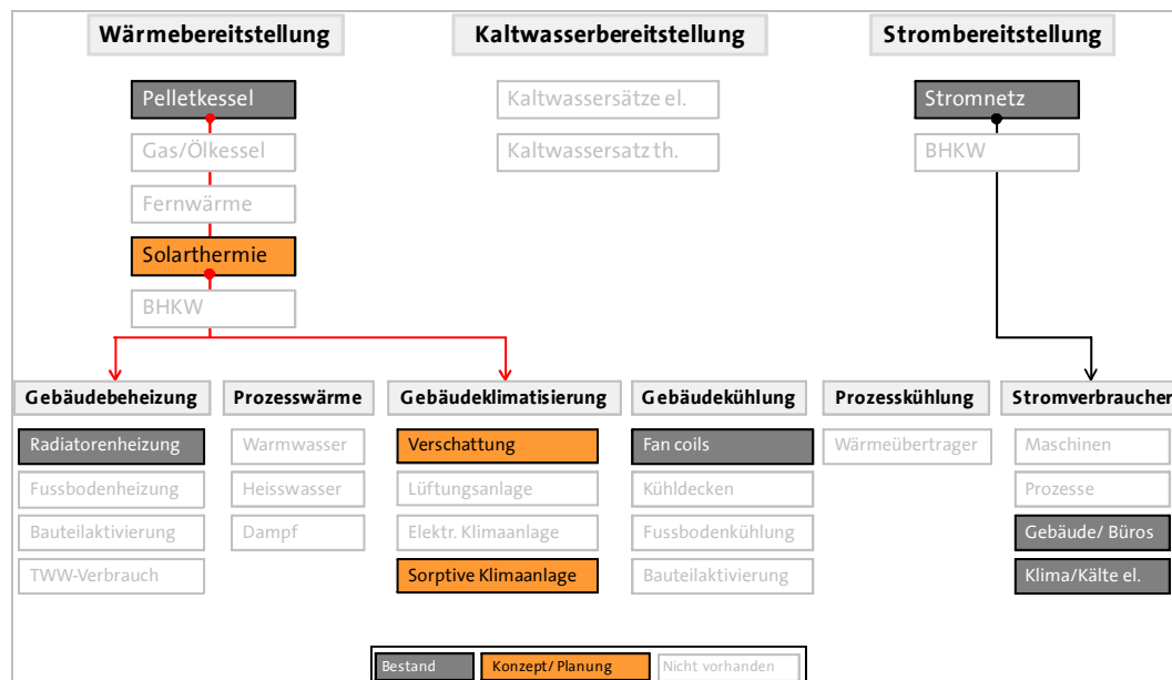
Abb. 1 Konzeption mit Einbindung in die bestehende Gebäudetechnik
